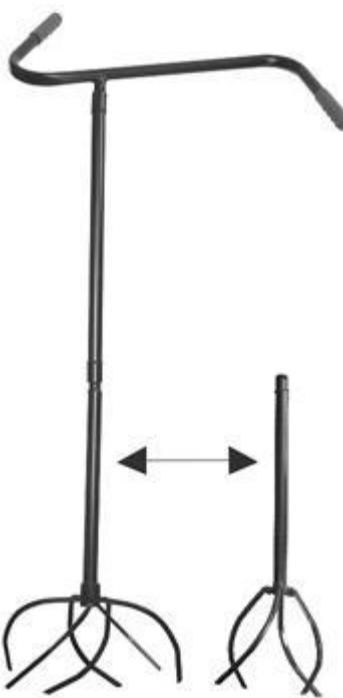
Рис. 6. Почвообрабатывающий агрегат «Краб»
